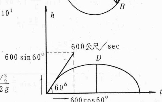
當  $t = \frac{V_0}{g}$  時，最大高度為  $\frac{V_0^2}{2g} = \frac{(600 \sin 60^\circ)^2}{2 \times 9.8} = 13776$  公尺
